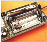
Il meccanismo di stampa. L'intero costruito nel corpo stampante, estratto da una Seisola GP 35
